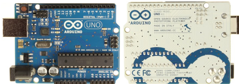
Gambar 2.1 Minimum sistem Arduino Uno R3
